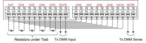
※ OUTPUT Bは 4Wire 抵抗測定時のみ使用します
