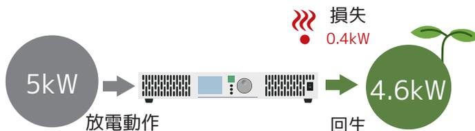
全て熱に変換する電子負荷装置に比べて試験がとってもエコロジー
