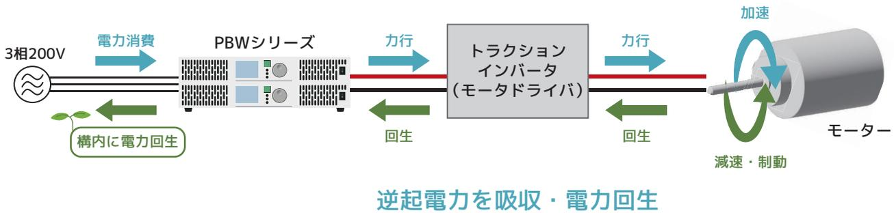
電力変換器（DC/DCコンバータや双方向電源等のパワーエレクトロニクス機器）
