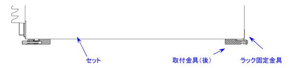
(5) ラック固定金具の背面パネルへの固定方法詳細図
