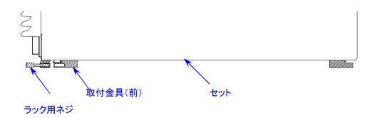
(4) ラック固定金具をセットに取り付け、取付金具(後)に固定する。
