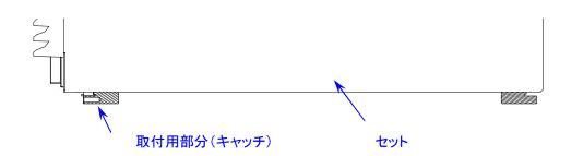
(3) 取付金具(前)とラック用ネジで、取付金具(中)に固定する。
