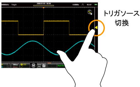
トリガレベルの変更 波形表示の右側を上下にスクロールするとトリガレベルが変更でき、ポップアップでレベルが数値で表示されます。
